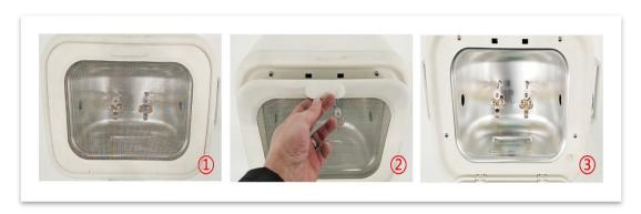
2. 用专用工具放置碳棒:使用撬铜工具下压碳棒传送轮,使用碳绑夹放置碳棒到传送槽中,松开撬铜固定碳棒。左右两边安装碳棒。
