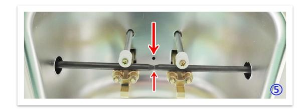
两只碳棒放置接触点尽量和反光罩中心孔在垂直线上
